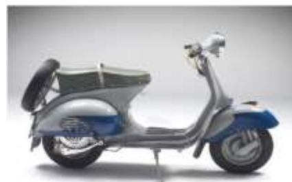
Мотороллер «Вятка», 1957–1966 годах, — легкого типа, отличается промежуточной ступени передач на колесо.
